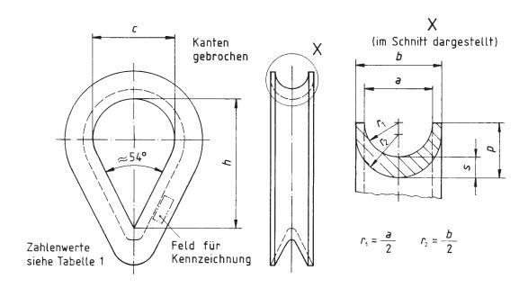
Bezeichnung einer Kausche aus Stahl für Faserseil (BF) von Nenngröße 20:
